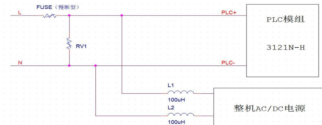
说明: 图中 PLC 信号接入点需要在压敏电阻(RV1)后面,压敏电阻结电容建议小于 600pF。PLC 信号后面需串接两个差模电感 (L1/L2) 与整机电源做隔离,差模电感感值推荐 50~100uH。
